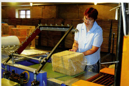
Kad parketa dēļi sarazoti, tos iepakoj gaīsa necaurlaidīgā materiālā, lai novērstu apkārtējās vides ietekmi. Arī noliktavā tiek uzturēta konstanta temperatūra un gaīsa mitrums.
